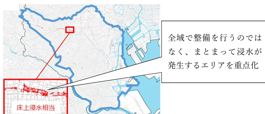
図表 3-2 1時間75ミリの流出解析シミュレーションイメージ
