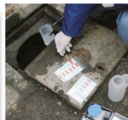
事業場排水の採水・水質検査
