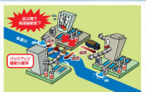
・多摩川をはさむ水再生センター間を結ぶ連絡管の相互融通機能を活用
