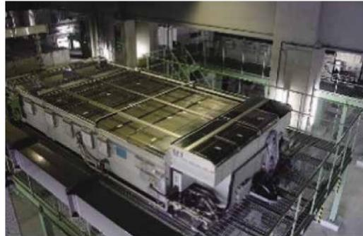
概要：従来の遠心力を利用する濃縮機に比べ電力使用量を大幅に削減
