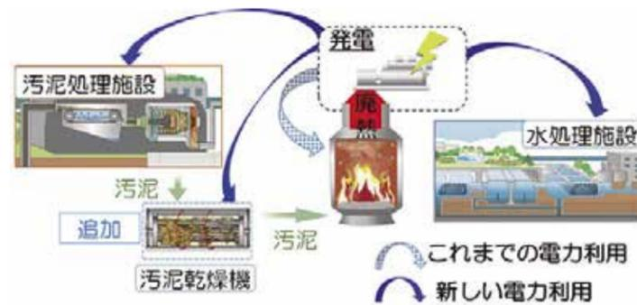
エネルギー供給型汚泥焼却システムのイメージ
