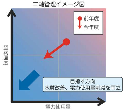
二軸管理図は、縦軸に窒素濃度、横軸に電力使用量を表しています。矢印の向きが左下に向かうほど理想的な傾向といえます。
