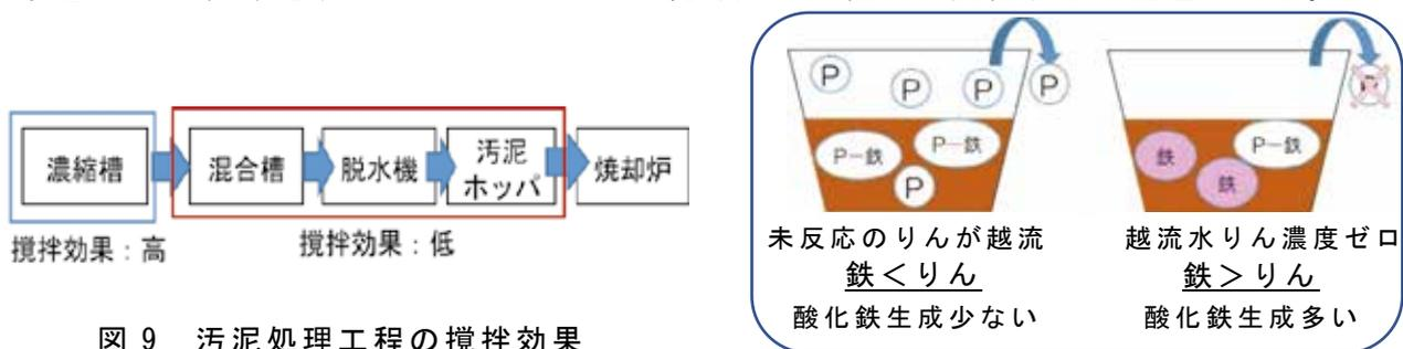
図9 汚泥処理工程の攪拌効果
