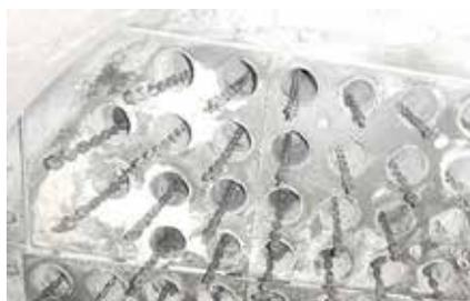
図11 流動空気予熱器内部
