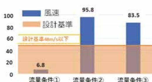
図6 RSN01人孔排気経路の最大風速
