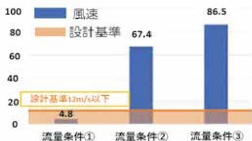
図5 RSN01人孔地上出口の排気風速
