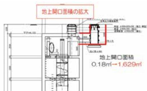
図8 最上流人孔A 地上開口面積の拡大
