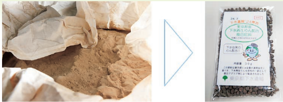
写真-5 製造した下水再生りんと下水道展で配布した試作品の複合肥料
