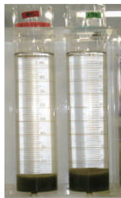
通常の汚泥 (沈殿している様子)
