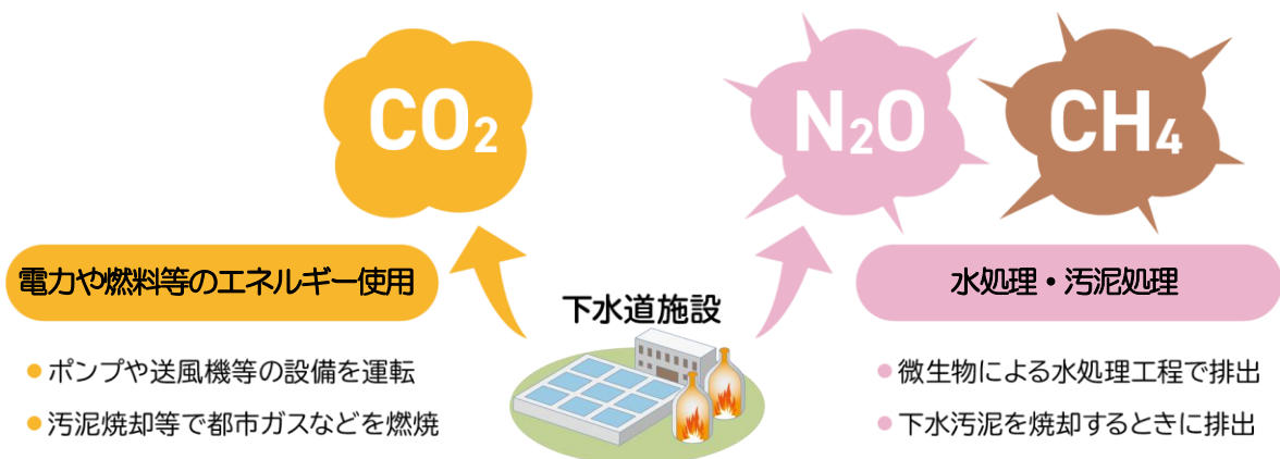
下水道施設から排出される主な温室効果ガス
