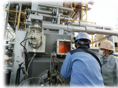
ミニチュア焼却炉（民間企業による仮設）での燃焼試験
