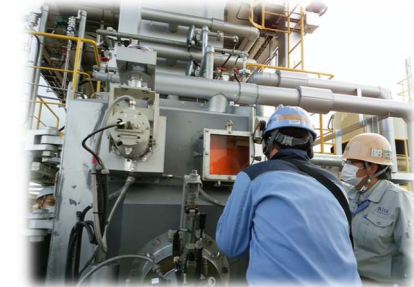
ミニチュア焼却炉（民間企業による仮設）での燃焼試験
