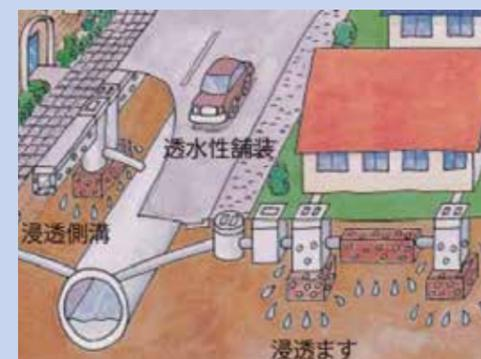
雨水浸透施設設置イメージ
