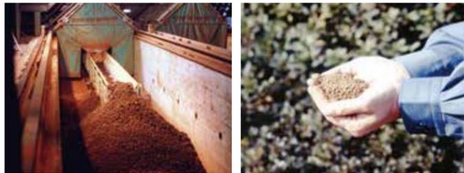
南多摩処理区は多摩ニュータウンの開発にあわせて整備されたため、工場排水に起因する有害物質が少なく、肥料に適していたため、コンポスト化し汚泥の減量化を図った。処理場内にコンポスト化施設を建設し、昭和62年度には、900t近くのコンポストを生産した。
