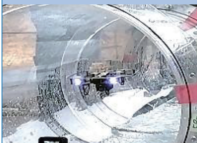
模擬管での ドローン飛行実験
