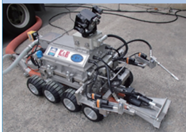
遠隔操作清掃ロボットの例
