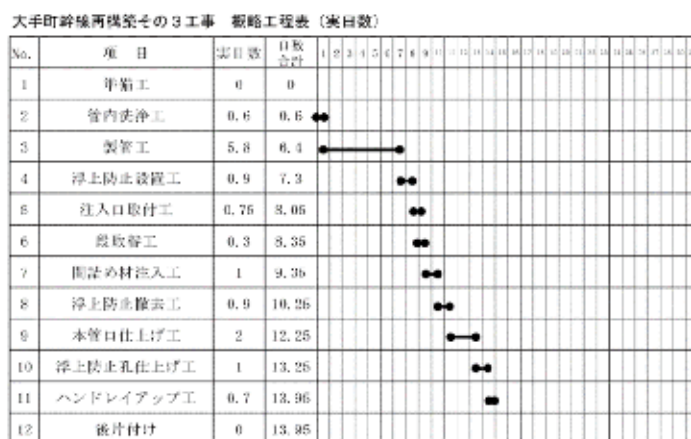
図 8 概略工程表（SPR-SE 工法のみ）
