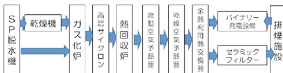
図1 2号炉焼却フロー
