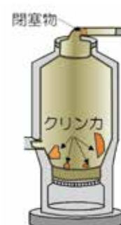
図1 焼却炉内部の焼結物
