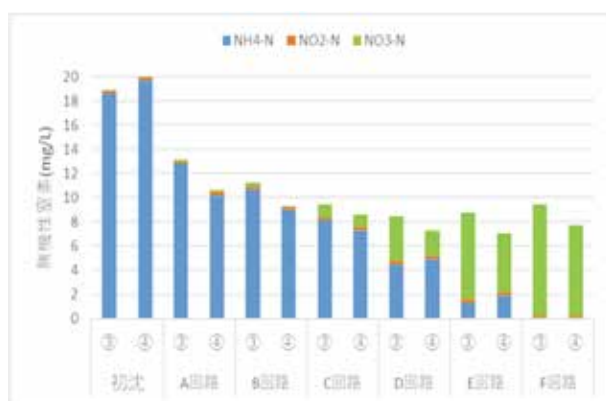
図9 高返送率運転による窒素処理状況
