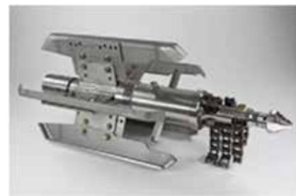
写真－２ チェーン回転 ノズル式清掃機器
