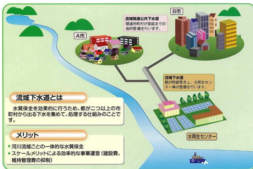
図 2－3 流域下水道のしくみ
