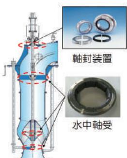
従来の無注水形先行待機雨水ポンプは、気中待機運転時間が1時間でしたが、軸封装置や水中軸受の耐久性を強化し、3時間にまで延長したポンプを開発しました。
