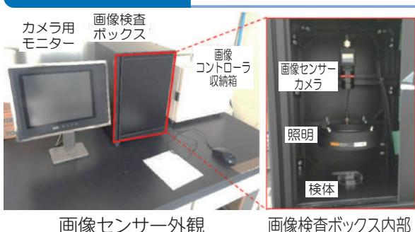
画像センサーにより焼却灰の色を測定し、AIによる深層学習から取得した推定式に適用することで、閉塞抑制指標値やりん含有率を推定し、閉塞抑制薬剤の最適な注入量を決定する技術です。薬剤注入量の決定が容易になり、りんに起因する焼却炉の煙道閉塞を防止し、汚泥処理の安定化に寄与します。
