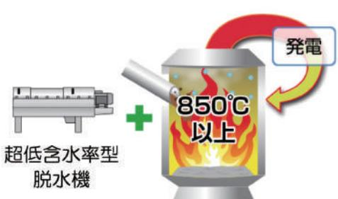
超低含水率型脱水機で脱水汚泥の水分量を一層削減して補助燃料を不要とするとともに、焼却廃熱の大部分を利用した発電により電気を自ら供給できるシステムです。従来型の焼却炉と比べ温室効果ガス排出量を約80%削減できます。新河岸水再生センターなど3センターで導入しています。
