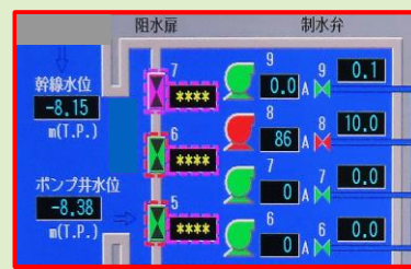
▲水位等を確認し、ポンプの運転管理、操作を実施
