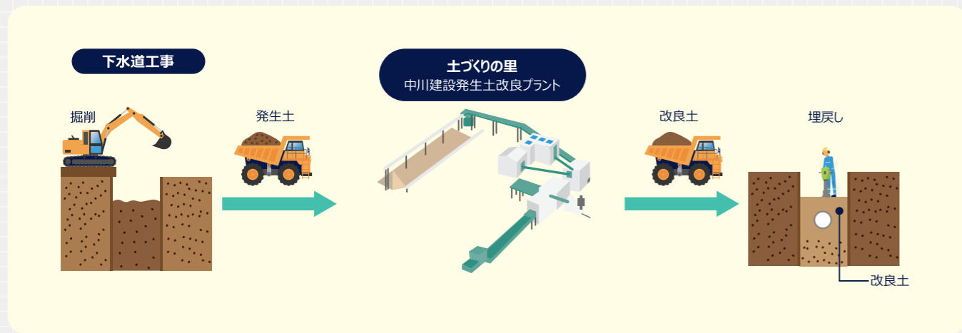
下水道工事における建設発生土のリサイクル
