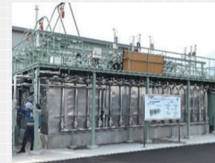
様々な水処理方法を再現できる水処理実験プラント (下水道技術研究開発センター内)
