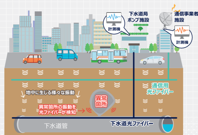
下水道光ファイバーを用いた地中の異常検知(イメージ)
