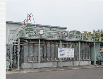
様々な水処理方法を再現できる水処理実験プラント (下水道技術研究開発センター内)
