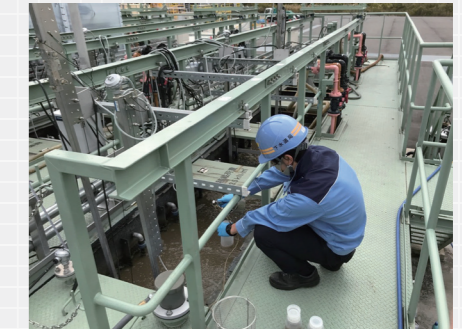
様々な水処理方法を再現できる水処理実験プラント (下水道技術研究開発センター内)
