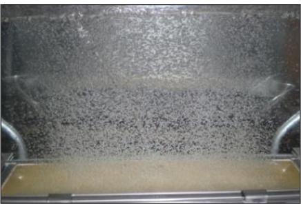
小さな気泡を発生させることにより下水に酸素が溶けやすくなり、送風機の電力使用量を削減
