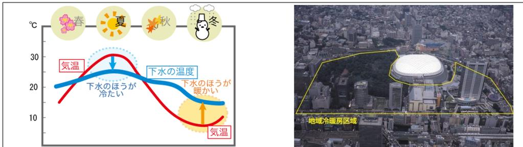
気温と比べ「夏は冷たく、冬は暖かい」下水の温度特性を活用し、水再生センター内で冷暖房用の熱源として利用するとともに、地域冷暖房の熱源として利用
