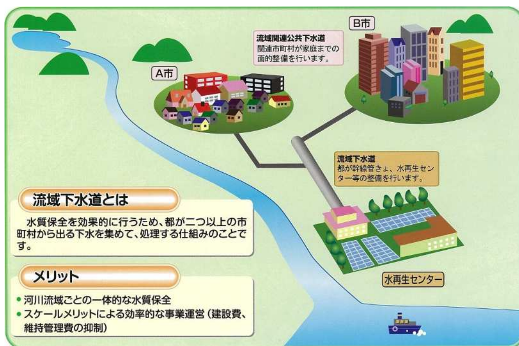
図 2 - 3 流域下水道のしくみ
