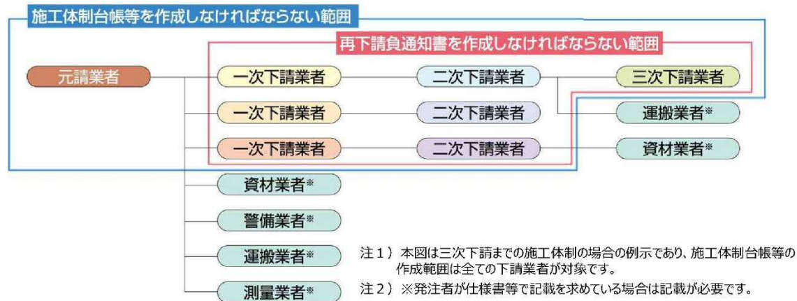
図 5 - 1 : 施工体制台帳の作成すべき範囲 (・三次下請までである場合の例)
