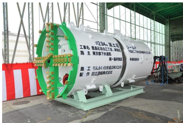
写真 2.2 シールドマシン
