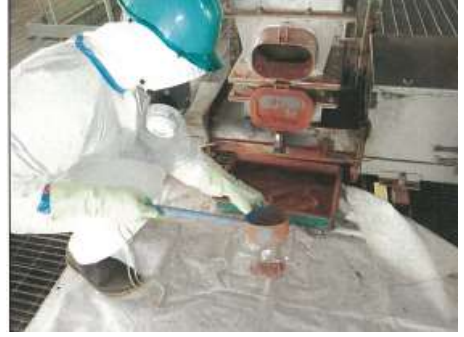
焼却灰の採取作業 (防護服着用)
