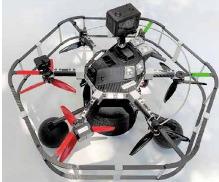
図-3 2点測位制御飛行式 UAV
