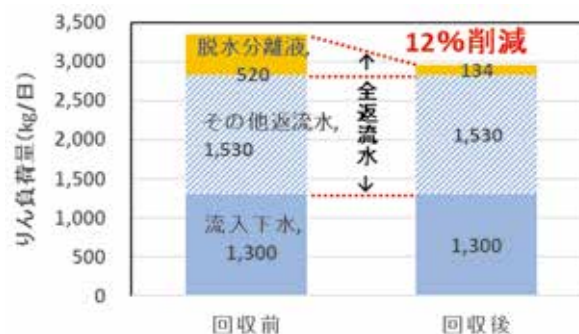
図 5 流入りん負荷量の削減効果 （砂町水再生センターでの試算結果）
