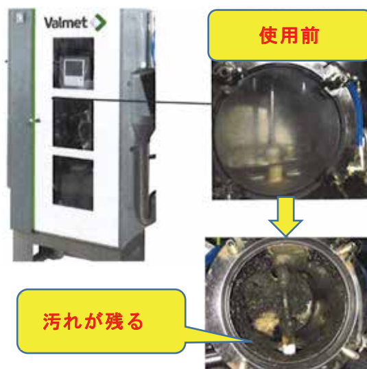
図6 コロイド電荷量計測定セル内部 右上：清浄な状態、右下：汚泥が付着した状態
