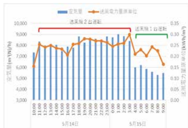
図3 既設送風機の消費電力分析
