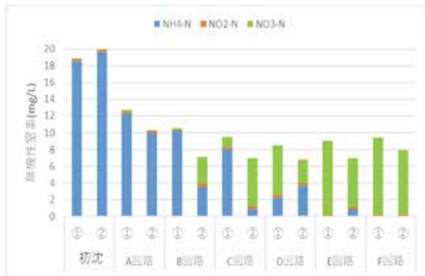
図7 ステップ流入有無の窒素処理状況
