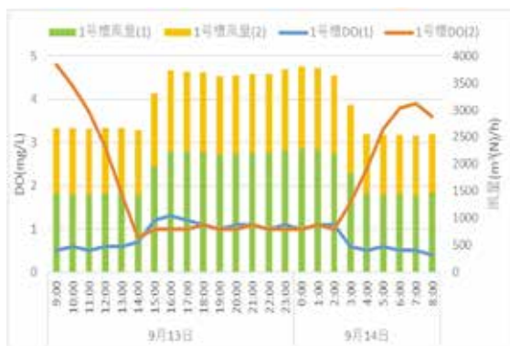
図 4 従来 DO 制御の空気量推移（1号槽）
