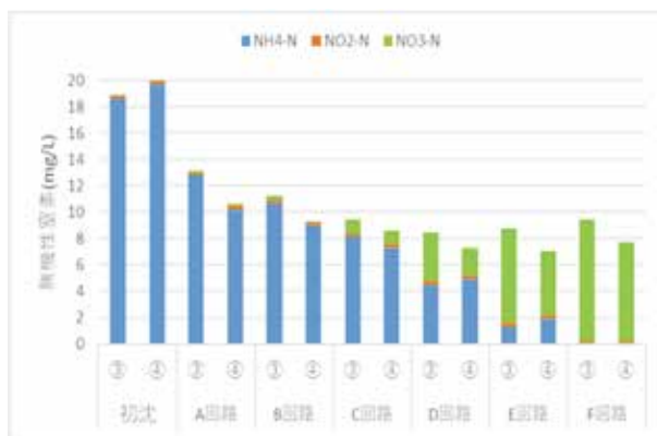
図9 高返送率運転による窒素処理状況
