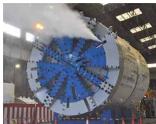
写真-1 D0-Jet 噴射テスト状況
